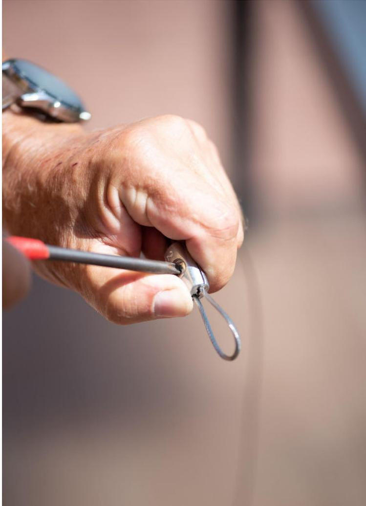
Hängen Sie das offene Ende des Spannseils in den Haken des Spanners und spannen Sie das Seil.
